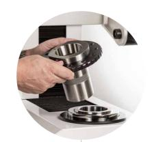
BUSSOLE PORTACONO INTERCAMBIABILI in acciaio temprato di alta precisione con run-out cono ±2µ.
