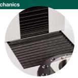
Il presetter PERFORMANCE può lavorare anche in ambiente industriale, grazie ai soffietti antipolvere a protezione di tutte le parti sensibili come righe ottiche e guide di scorrimento. High PERFORMANCE dust guards maintain the presetter guides and sliders in perfect shape at all times. The presetter can work in difficult conditions.
