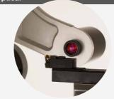
Telecamera HD con obiettivi telecentrici. Campo di visione di 7x7 mm e 40x ingrandimenti. Permette sia la misurazione utensile con risoluzione 0,001mm che l'ispezione utensile in modalità Real View. Telecentric lenses on the HD main viewing cameras. Field of vision of 7 x 7 mm and 40x enlargement. Tool measuring, with 0,001mm resolution, and inspection is possible in Real View mode is possible.
