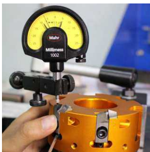
5. 用轴向调节螺钉将所有刀夹高度调至目标尺寸-0.01，用14.5Nm力拧紧刀夹压紧螺钉，用2.5 Nm力拧紧侧面压紧螺钉。
