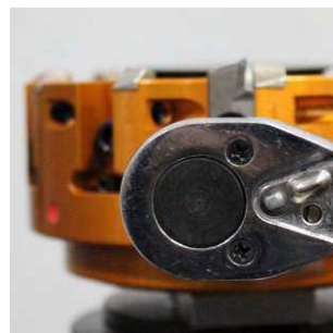
4. 将刀夹装入刀夹座，刀夹底部贴紧轴向调节螺钉，用4.5Nm力预紧刀夹压紧螺钉，用1 Nm力预紧侧面压紧螺钉。
